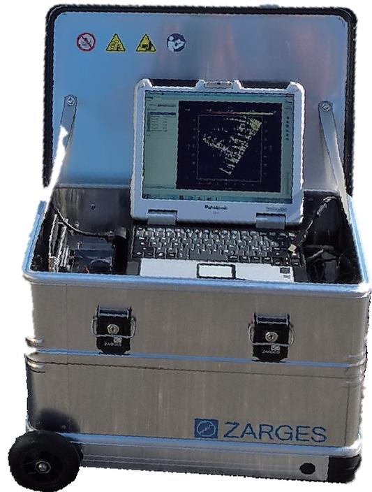
터널, 사면 댐, 빌딩 3D 모니터링을 위한 간섭 레이더 시스템
